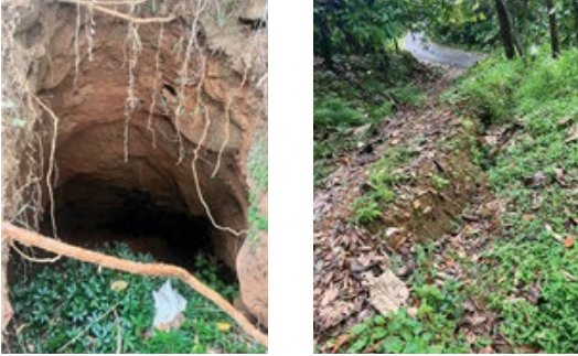
चित्र 3.2.2.1 : (बाएँ) केलाकम गांव में ओवरबर्डन का विस्थापन। (दाएँ) थंकामनी गांव में मृदा पाइप का प्रवेश द्वार।
